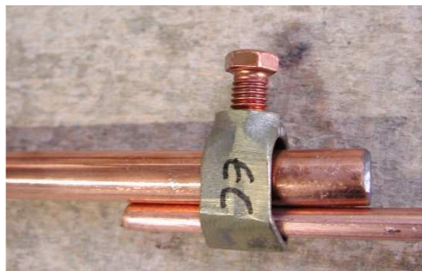
Καινούργια ράβδος με ηλεκτρολυτική επιχάλκωση με πάχος 250µm
