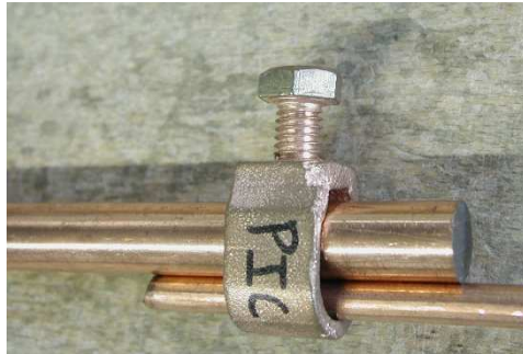
Καινούργια ράβδος με ηλεκτρολυτική επιχάλκωση με πάχος 50µm
